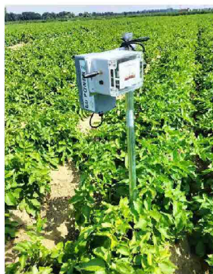
Alcuni sensori di ultima generazione per la raccolta di informazioni sul contenuto idrico della pianta e del suolo testati presso l'Acqua Campus del Cer (Canale Emiliano Romagnolo)
