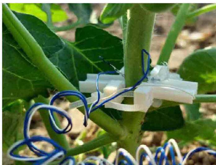
Alcuni sensori di ultima generazione per la raccolta di informazioni sul contenuto idrico della pianta e del suolo testati presso l'Acqua Campus del Cer (Canale Emiliano Romagnolo)
